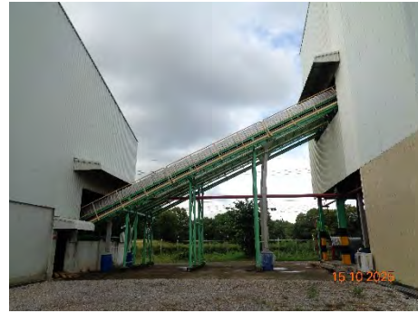
ภาพที่ 2-14 สายพานลำเลียงเชื้อเพลิงชีวมวล แบบระบบปิด
